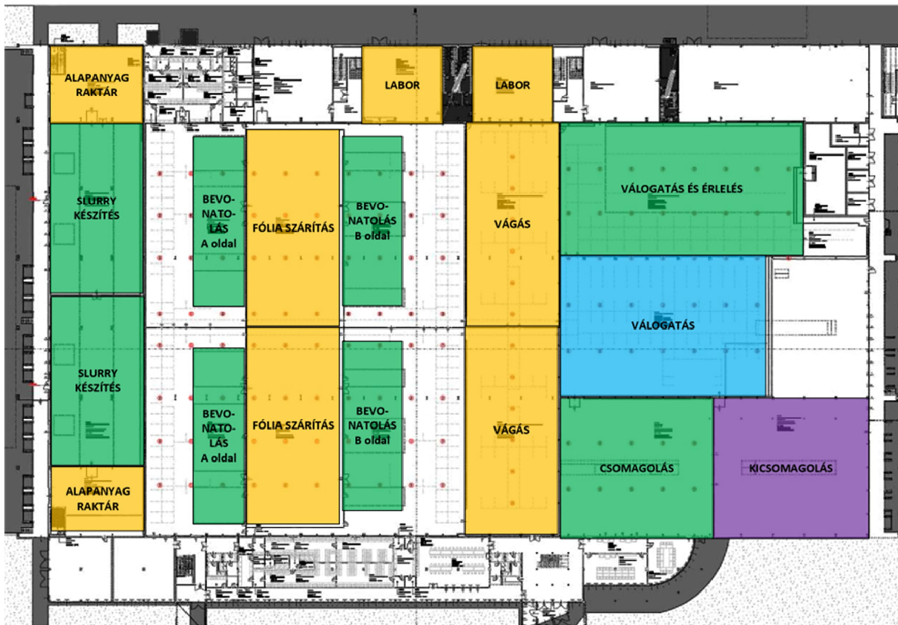
5. ábra. Technológiai folyamatok épületen belüli elhelyezkedése
